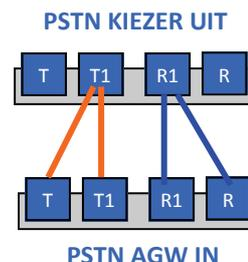
Altijd op deze manier aansluiten. Hierdoor wordt ook deze verbinding door de SATCD bewaakt. Anders aansluiten leidt tot storingen
